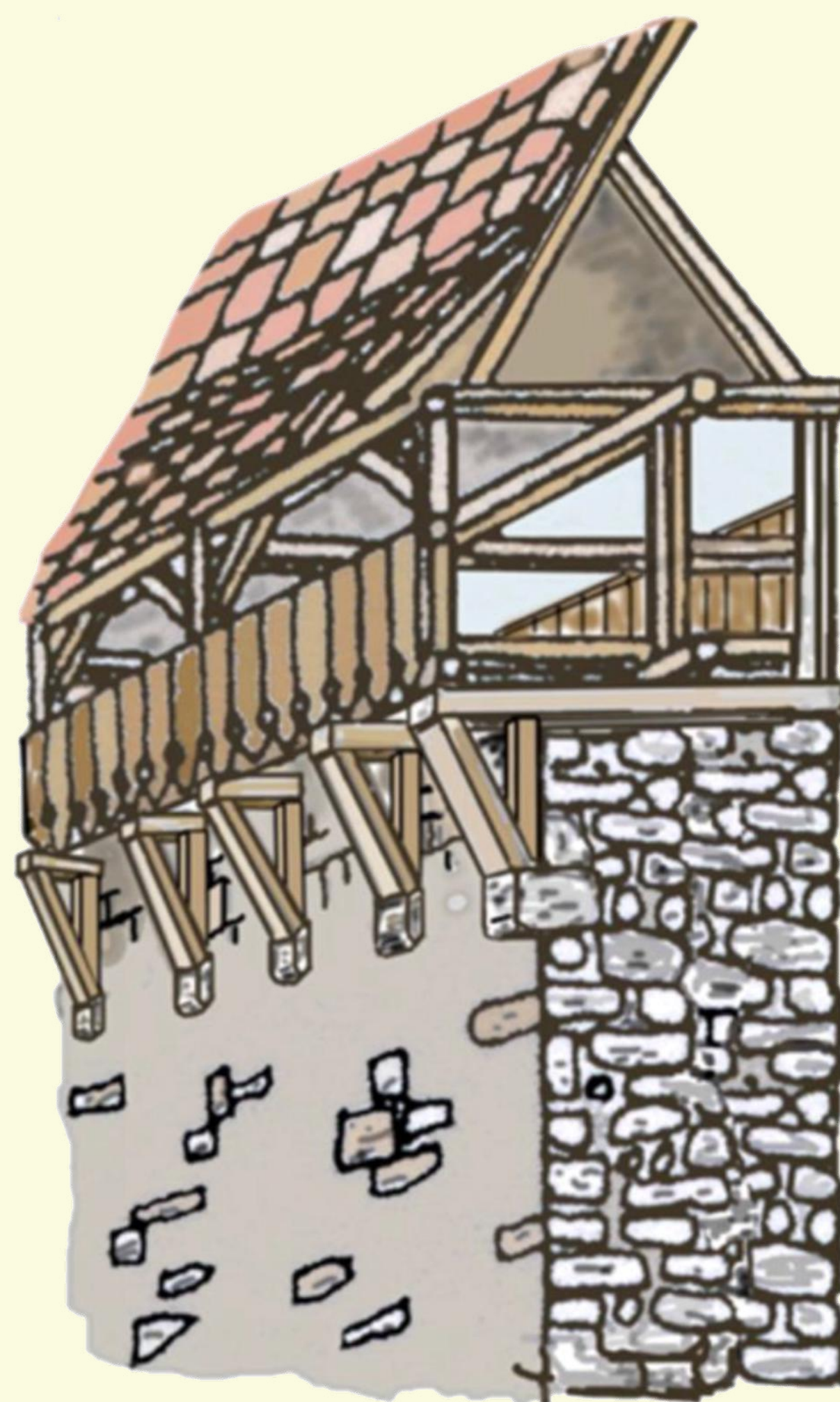
Wehrgang auf der Mauer ruhend, dessen Überbreite über Holzstreben auf Konsolsteinen abgestützt ist
